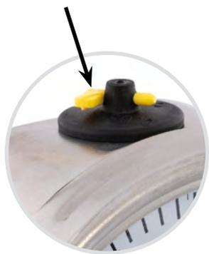
Au cas où un manomètre est équipé d'une paroi arrière éjectable, celle-ci doit être protégée contre un blocage provoqué par la présence de débris ou de saleté. Pour les manomètres de sécurité, il doit y avoir un espace libre derrière la paroi arrière éjectable d'au minimum 20 mm. Après montage, ouvrir le levier de mise à l'atmosphère (si disponible) ou basculez-le de CLOSE sur OPEN.
